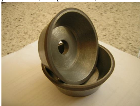
Рис. 1. Шліфувальні круги форми 11V9 з композиційним корпусом
