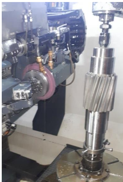
Рис. 1. Установка шліфувального круга з рубін-корунду на верстаті
