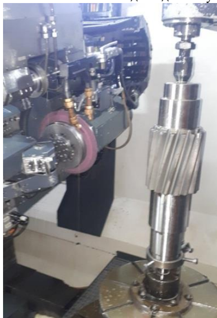
Рис. 1. Установка шліфувального круга з рубін-корунду на верстаті
