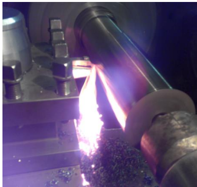
Рис. 2. Точіння із швидкістю різання v = 250 м/хв. заготовки із загартованої сталі ШХ15 (62 HRC) інструментом, оснащеним різальною пластиною RNMN 09T300F із партії № 24
