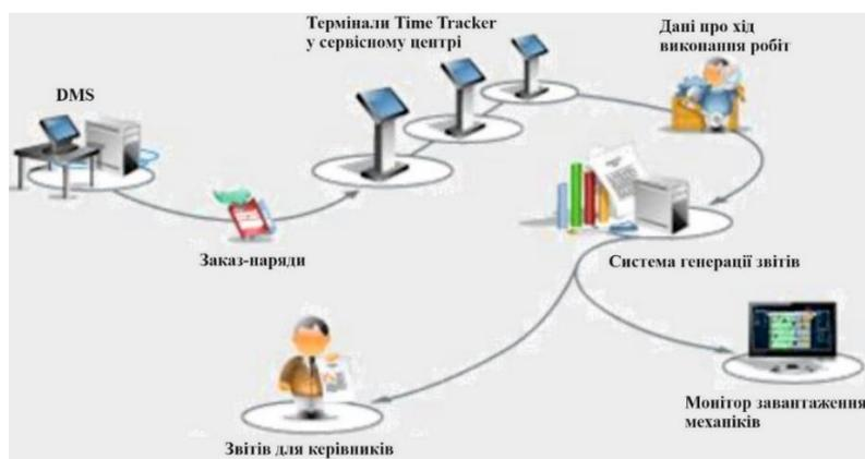
Рис. 1. - Загальна схема роботи системи Time Tracker
