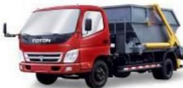
Рис. 3 – Контейнерний смітєвоз із гачковим автоматом підйому для контейнерів об'ємом 8 м<sup>3</sup> для збирання великогабаритних відходів
