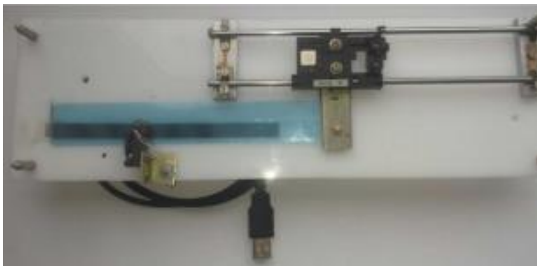
Рис. 2 – Загальний вигляд діючої моделі датчика лінійних переміщень на муаровому ефекті
