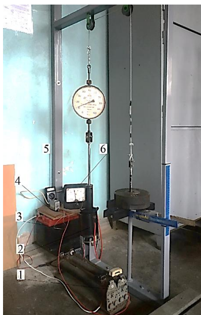
Рис. 1 – Електрообладнання імітаційно-випробувального стенду:
