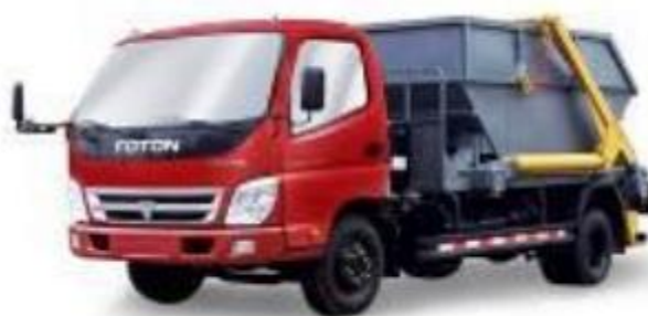
Рис. 3 – Контейнерний смітєвоз із гачковим автоматом підйому для контейнерів об'ємом 8 м 3 для збирання великогабаритних відходів
