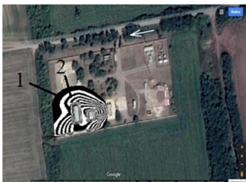
Рисунок – Зона забруднення атмосферного повітря, розрахунок виконаний з урахуванням будинків на території насосної станції
