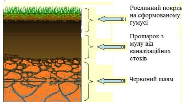
Рис. 1. Схема формування захисного бар'єру на агресивній поверхні техногенного масиву
