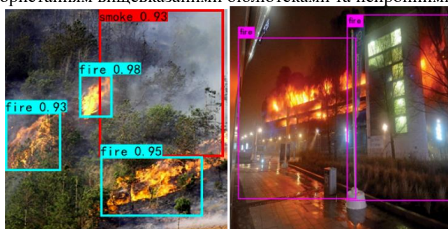
Рис. 2. Реалізація виявлення пожежі за допомогою технічного зору
