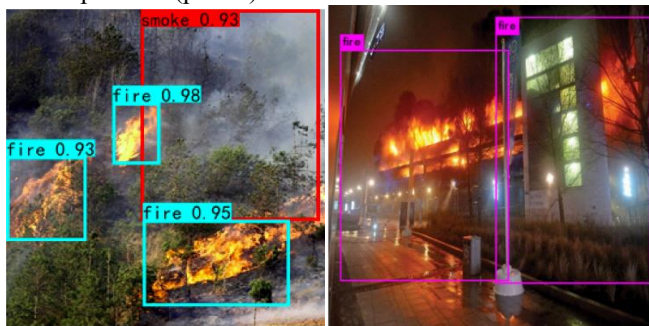
Рис. 2. Реалізація виявлення пожежі за допомогою технічного зору
