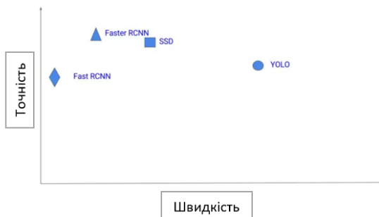
Рис.1. Порівняння роботи методів виявлення об'єктів
