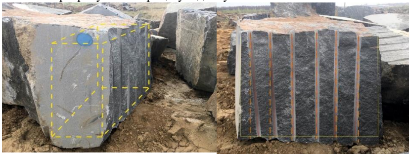
Рис. 1. Блок, відокремлений буроклиновим способом
