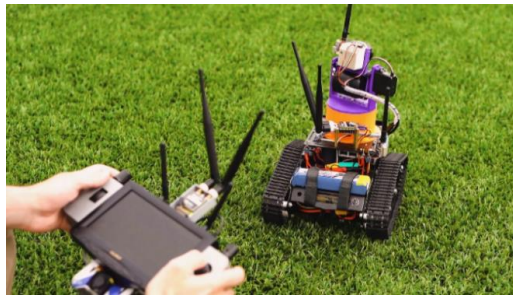
Рис. 1. Мобільна платформа з автономною системою стабілізації для вимірювання теплових показників об'єктів
