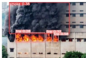
Рис. 2. Виявлення вогню та диму на зображенні за допомогою YOLO та попередньо навченої моделі
