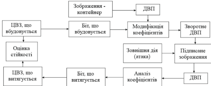
Рисунок 2 – Схема оцінки стійкості цифрових водяних знаків
