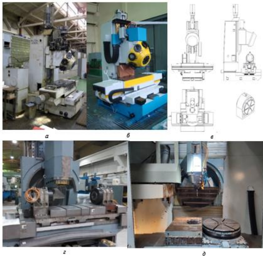
Рис. 1. Варіанти модернізації верстата з ЧПК MA-655 A2:
