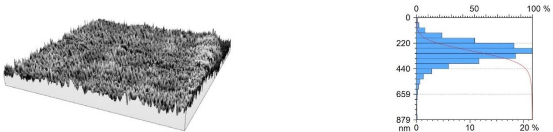
Рис. 4. Поверхня після MAO з робочим зазором 2 мм отриманої на ділянці 2x2 мм на мікроскопі NanoFocus, дискретний і інтегральний характер розподілення висоти мікронерівностей на наведеній ділянці
