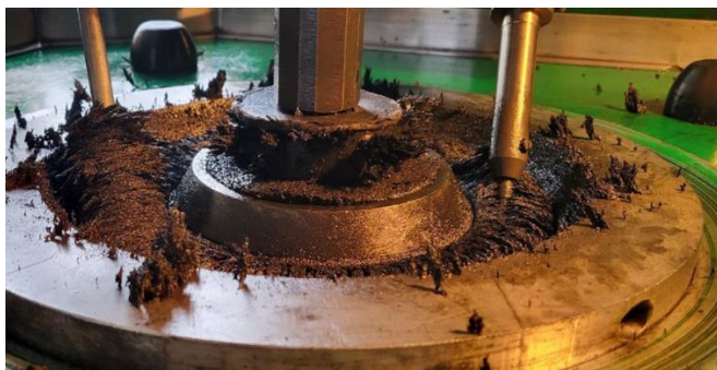
Рис. 1: Характер витіснення частинок МАІ із робочої зони під час обробки
