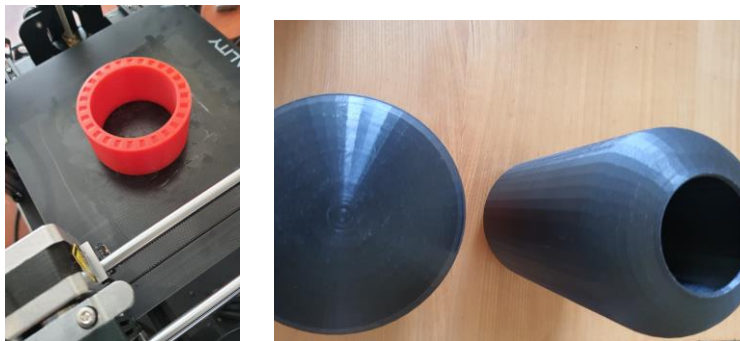
Рис. 1. Друкування зразків для механічних випробувань та тестові зразки
