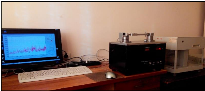
Рис. 1. Зовнішній вигляд установки для випробування ливарних сплавів на зношування в умовах сухого тертя
