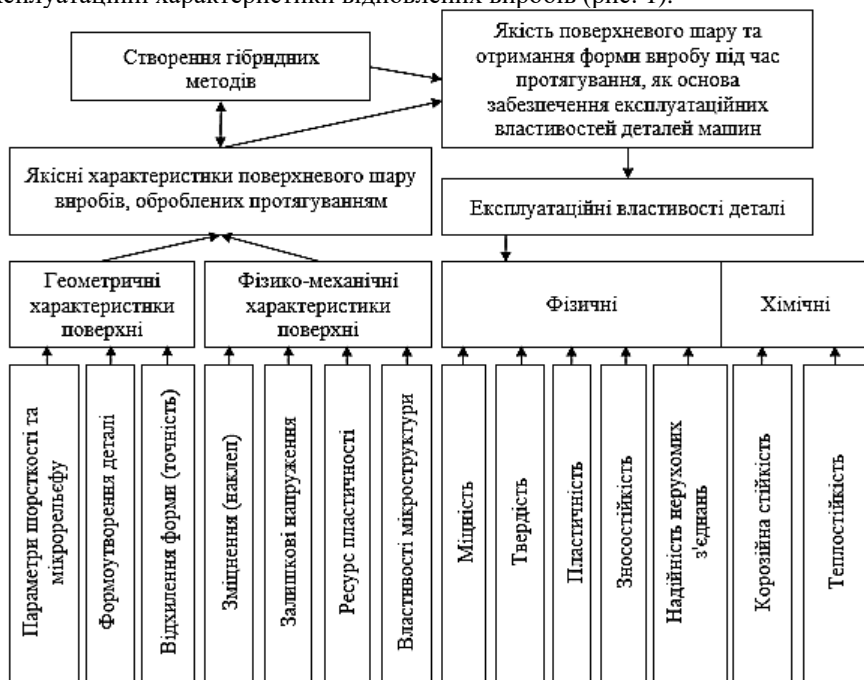
Рис. 1. Схема створення нових технологічних методів інженерії поверхні на основі деформуючого протягування, які покращують експлуатаційні властивості відновлених деталей
