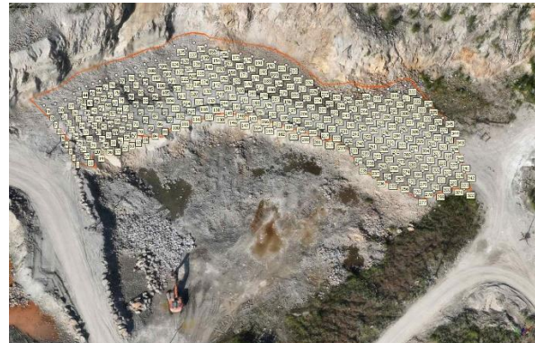
Рис. 2. Розташування свердловин в паспорті буровибухових робіт на Березівському-1 родовищі граніту
