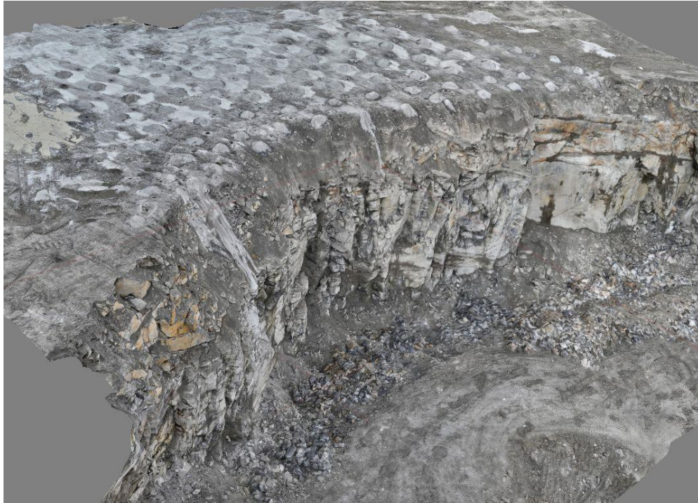
Рис. 3. Модель блока з фактичним розташування свердловин в паспорті буровибухових робіт на Березівському-1 родовищі граніту
