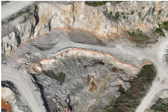
Рис. 1. Модель блоку підготовленого до вибуху на Березівському-1 родовищі граніту
