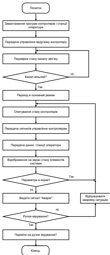
Рис. 1. Блок-схема алгоритму роботи комп'ютеризованої системи для вимірювання та контролю якості нафтопродуктів
