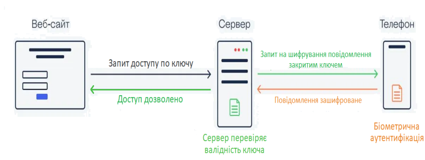
Рис. 2. Приклад проведення аутентифікації за допомогою технології Passkeys
