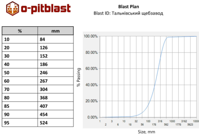
Рис. 1 Фрагментаційний розподіл гірської маси за базовою моделлю Куз-Рама
