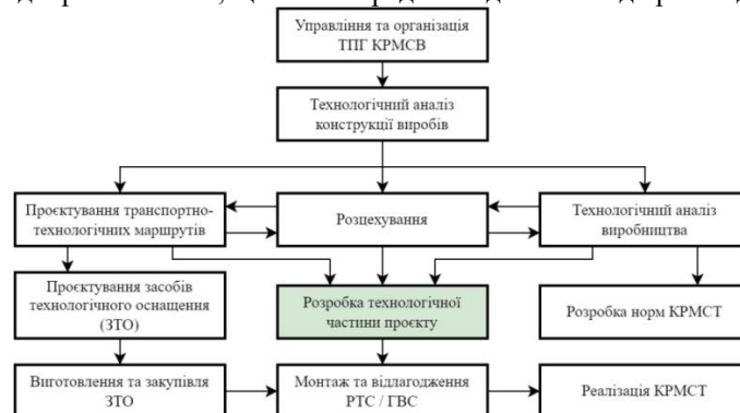
Рис. 1. Спрощена схема основних етапів ТПГ КРМСВ
