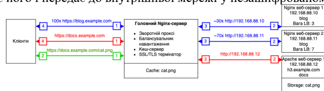
Рис. 1. Діаграма інфраструктури тестового проекту веб-сервера на базі Nginx
