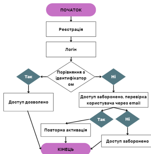
Рис. 1. Блок-схема запропонованої системи
