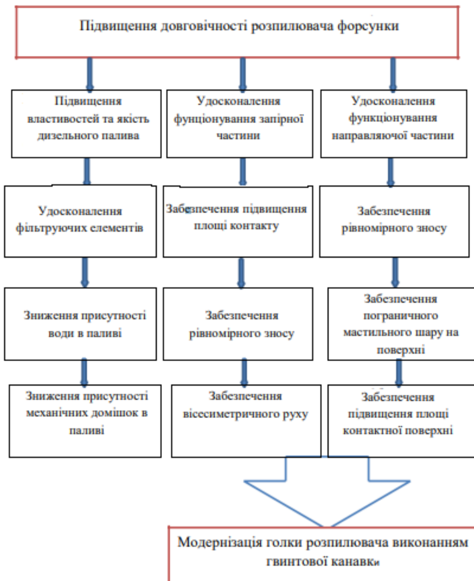
Рис. 1. Схема підвищення довговічності розпилювача форсунки
