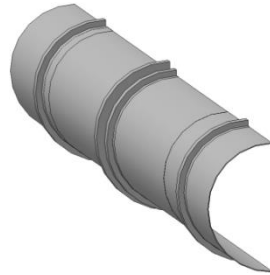
Рис. 1. Розрахункова електронна (комп'ютерна) модель корпусу установки відпалювання руди
