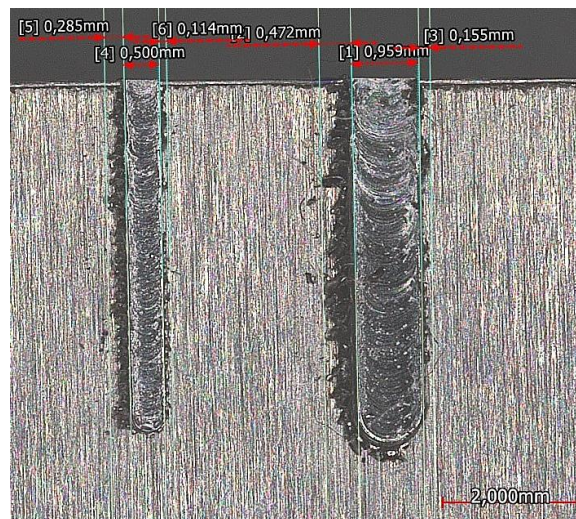
Рис. 1. Пази, отримані мікрофрезеруванням аустенітного сплаву Ni_{56,5}Ti_{43,5} :
