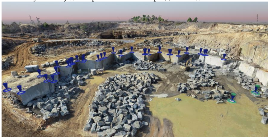
Рис. 2. Цифрова модель кар'єру з відображенням наземних контрольних точок та контрольних точок вершин уступів. (Сині маркери – контрольні точки вершин уступів, зелено-сині маркери – контрольні наземні точки, що використовувалися для калібрування знімків).
