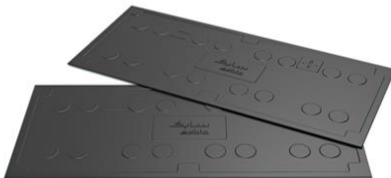
Рисунок 3. Кришка блоку батарей, сформована з використанням смоли Stamax FR, яка відповідає рейтингу горючості UL94 V-0 [6].
