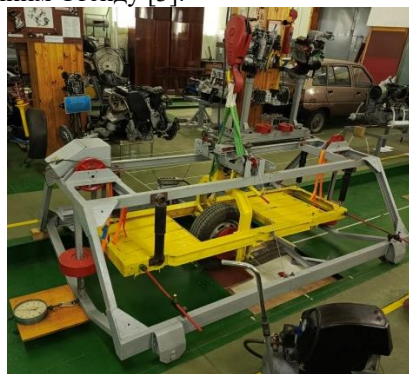
Рисунок 2 – Загальний вигляд Стенду (а) та його кінематична схема (б)
