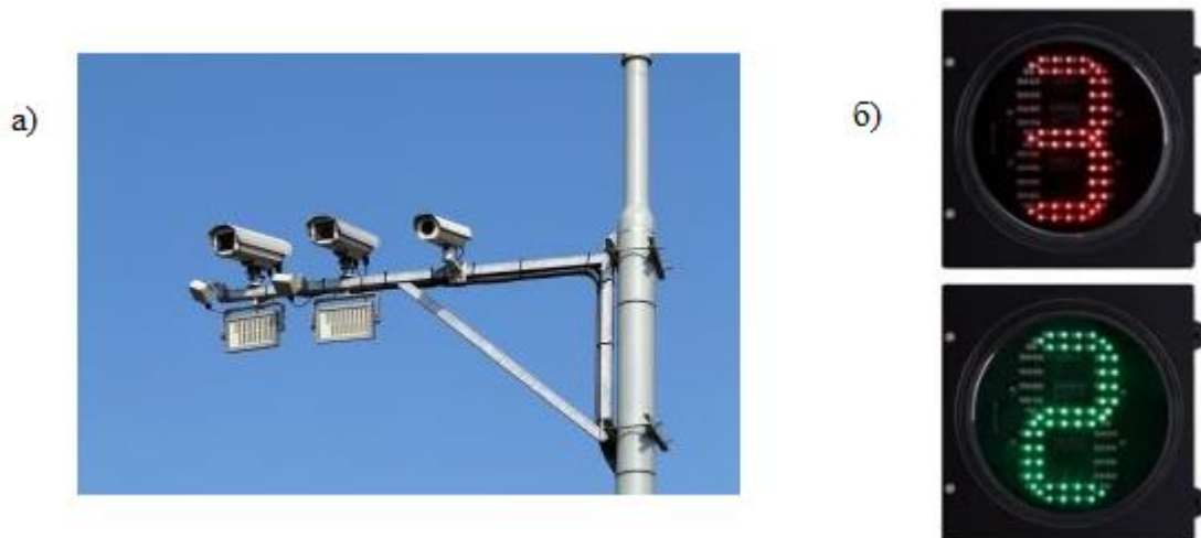
Рисунок 1 – Оптичні засоби дослідження дорожньої обстановки: а – відеокамери; б – світлодіодні індикатори
