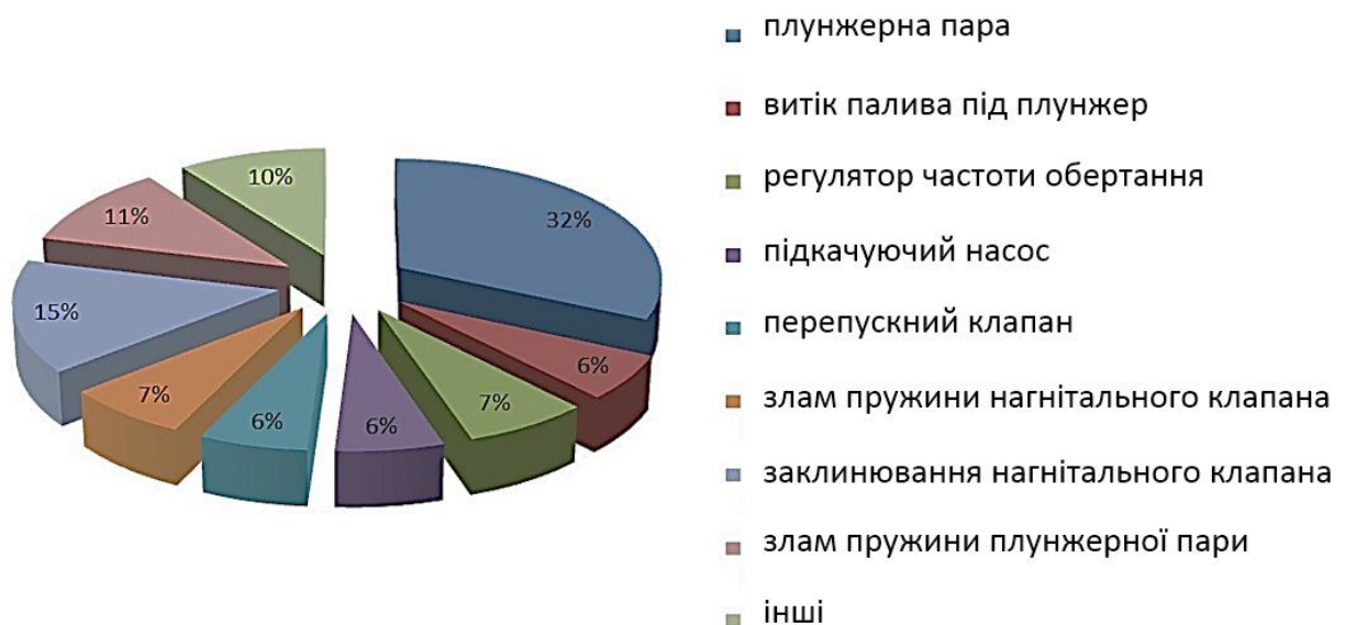
Рисунок 1 – Розподіл відмов елементів системи живлення дизельних двигунів Можливість появи відмов паливної апаратури дизельних двигунів P(T) розраховується за формулою:
