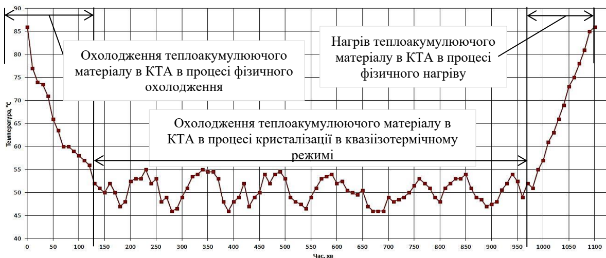
Рисунок 1 - Результати дослідження КТА у режимі зберігання накопиченої теплоти від привідного двигуна при температурі оточуючого середовища +20 °C
