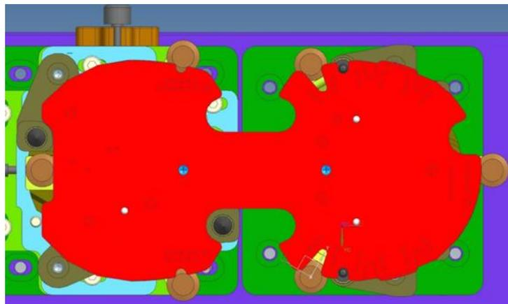
Рисунок 9 - 3D CAD-модель вигляду знизу затиснутої друкованої плати
