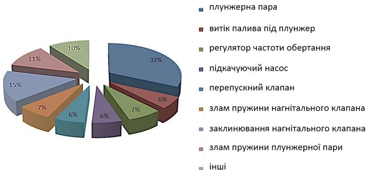
Рисунок 1 – Розподіл відмов елементів системи живлення дизельних двигунів
