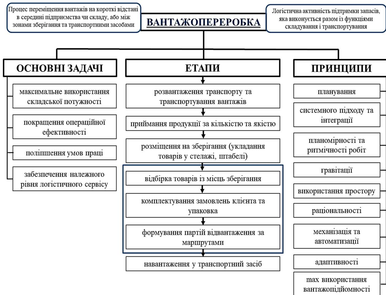
Рисунок 1 – Схема системи вантажопереробки на складі
