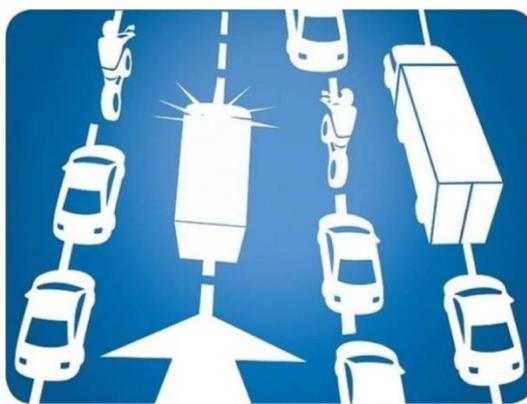
Рисунок 1 – Схема створення аварійного коридору
