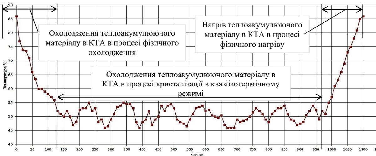
Рисунок 1 - Результати дослідження КТА у режимі зберігання накопиченої теплоти від привідного двигуна при температурі оточуючого середовища +20 °С
