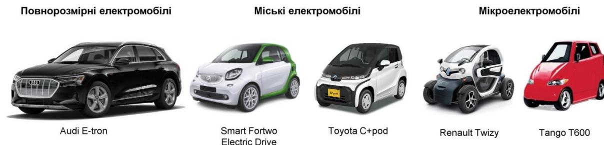
Рисунок 1 – Види електромобілів в залежності від габаритних розмірів
