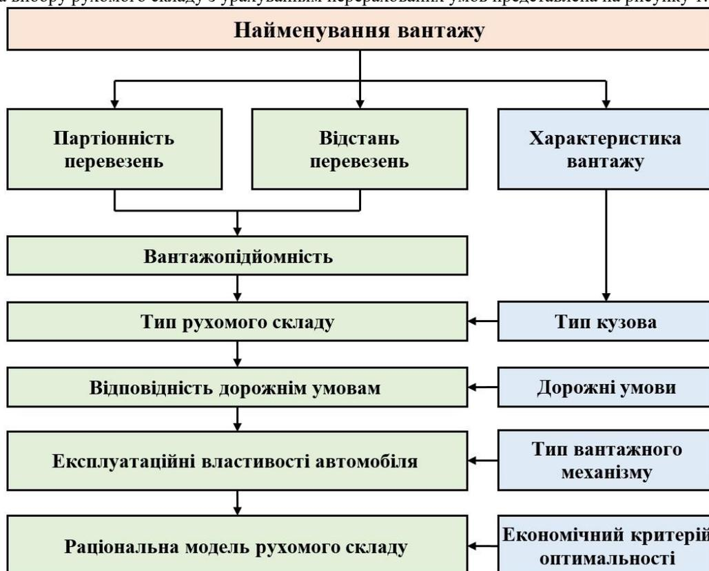
Рисунок 1 – Схема і критерії вибору вантажних автомобілів
