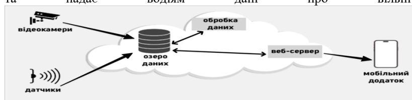
Рис.1. Потік інформації в системі паркування
