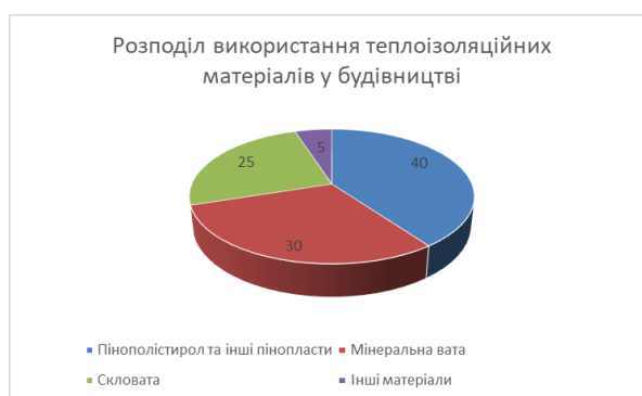
Рис. 1 Розподіл використання теплоізоляційних матеріалів у будівництві
