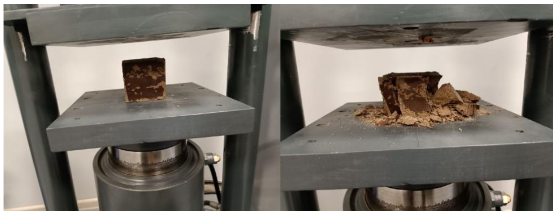
Рис. 1. Геополімерні зразки, що випробовувалися на міцність
