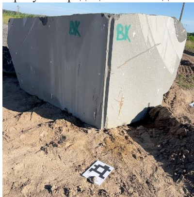
Рис. 1 Закладення опорної точки GCP
