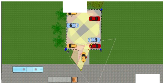
Рис.1 – Симуляція розташування камер на парковці
