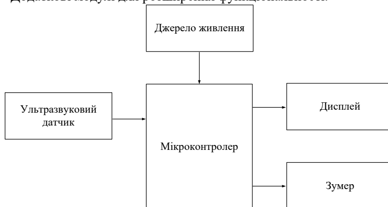
Рис. 1. Структурна схема комп'ютеризованої системи для визначення рівня рідини у резервуарах хімічного виробництва
