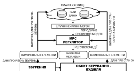
Рис. 1. Структурна схема запропонованої системи енергоефективного керування температурою повітря у будівлях з автономним опаленням на основі MPC-регулятора
