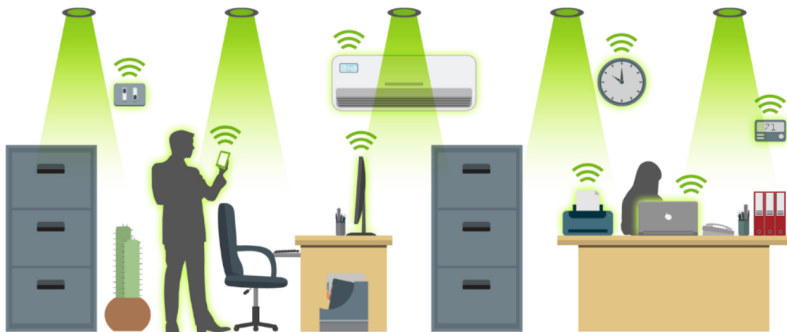
Рис. 1.2. Принцип роботи Li-Fi
