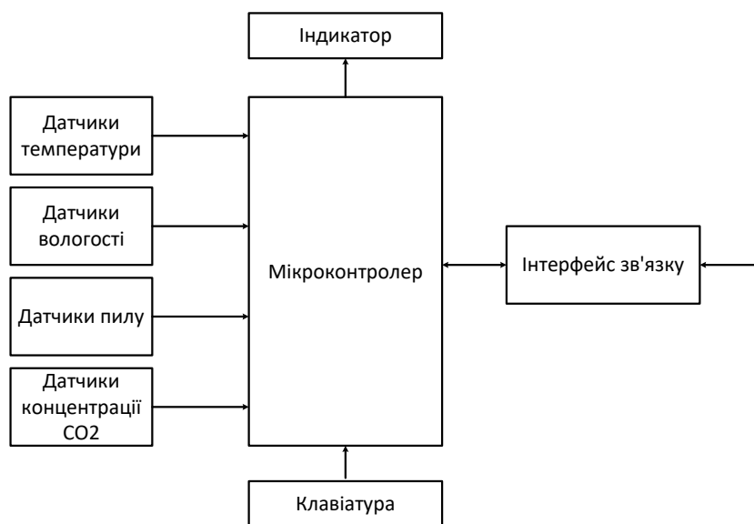
Рис. 1. Структурна схема комп'ютеризованої інформаційно-вимірювальної параметрів мікроклімату виробничого приміщення
