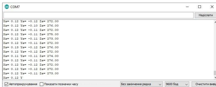
Рис. 2. Робота акселерометра ADXL345 при калібруванні вісі Z
