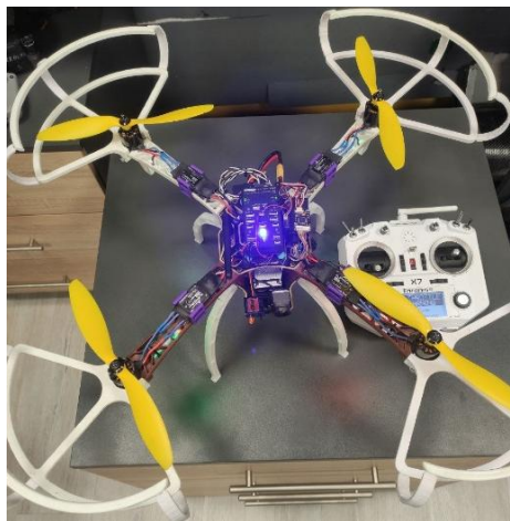
Рис. 1. Прототип мультироторного дрона з системою навігації GPS
