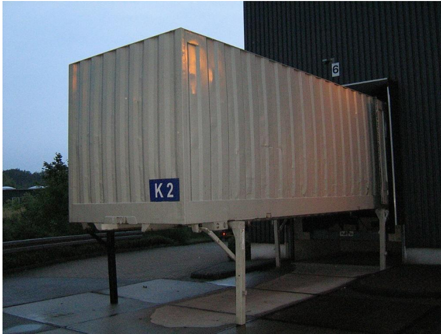
Рис. 1. Використання опор для завантаження модуля на шасі
