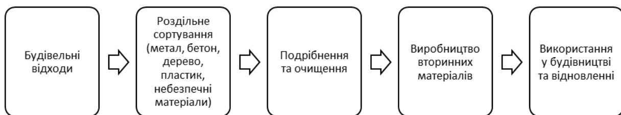
Рисунок 1 - Процес переробки будівельних відходів у вторинні матеріали
