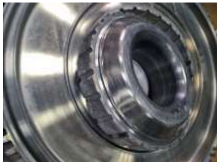
Рис. 1. Розрізаний диск турбіни
