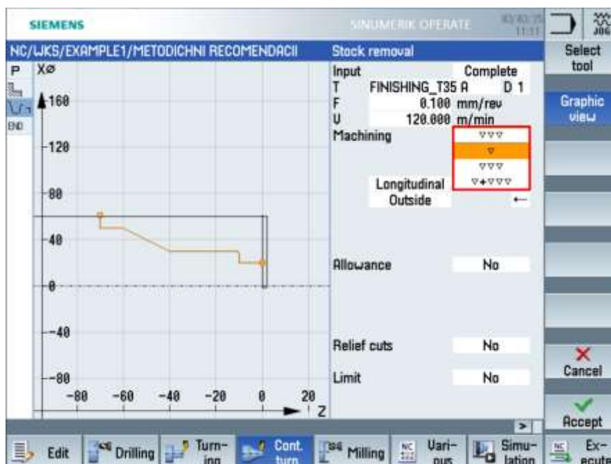
Рис. 1. Приклад параметричного контуру деталі в середовищі SinuTrain
