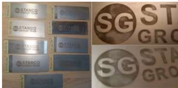
Рис. 2. Дослідні зразки нержавіючої сталі з результатами маркування методом електрохімічного травлення
