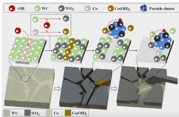
Рис. 1. Механізм видалення матеріалу з сплаву карбід вольфраму з кобальтом методом C-STP з реагентом Фентона [2]
