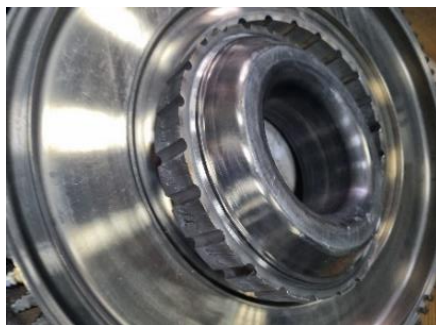
Рис. 1. Розрізаний диск турбіни
