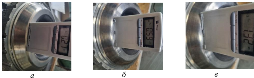
Рис. 3. Шорсткість торця диску турбіни після точіння твердосплавним інструментом (а), ППД алмазними наконечниками (б), шліфування абразивними кругами з рубін-корунду (в)
