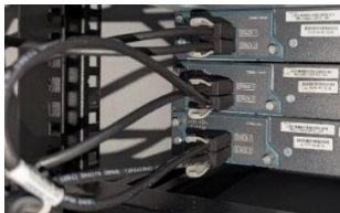
Рисунок 2 - Кільцева топологія стеку Cisco Catalyst 2960-SF
