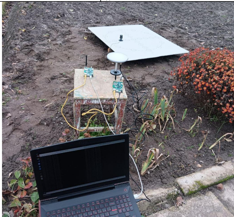
Рисунок 1 – Експериментальний стенд для вимірювання точності GNSS у режимі RTK
