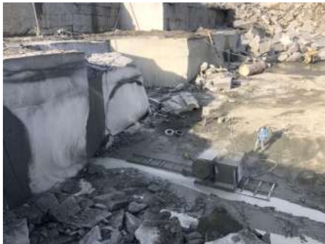
Рис. 1. Застосування алмазної канатопильної установки для видобування блоків гранодіориту
