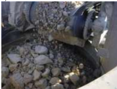
Рис. 1. Сегрегація матеріалу при завантаженні у конусну дробарку
